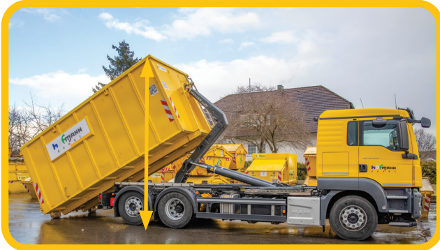
Fahrzeughöhe beim Auf/Absatteln des Containers
